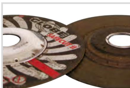
Il rinforzo del centro depresso con la speciale cupola in acciaio, evita possibili rotture dovute al contatto della cupola stessa con il pezzo che si sta tagliando.
